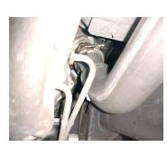
INSTALL DOWN PIPE #A ONTO YOU TURBO USING YOUR FACTORY CLAMP. INSERT WELDED HANGER INTO THE LOWER HOLE IN THE RUBBER GROMMET. DO NOT TIGHTEN.
