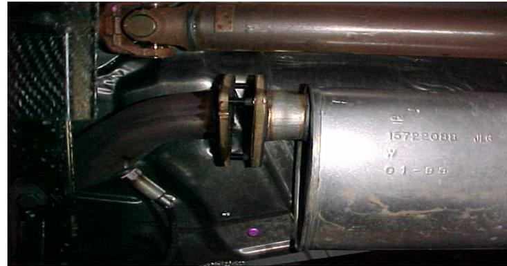
**2.** UNBOLT STOCK MUFFLER FLANGE AT THE STOCK CONVERTER. REMOVE THE STOCK MUFFLER. MAKE SURE ALL RUBBER GROMMETS ARE STILL IN PLACE.
